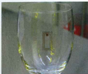
図2 FIJ技術で印刷したワイングラス IJユニット内の3軸駆動機構と、ロボットによる動作を組み合わせ、曲面上に回路を印刷できる。
